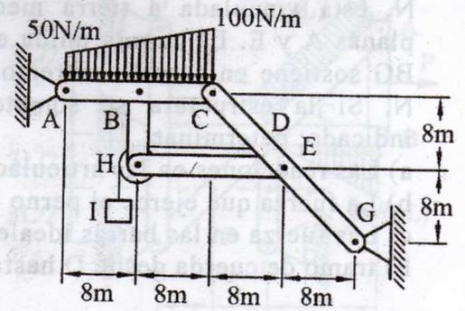
78.- La estructura mostrada formada por cuatro barras de pesos despreciables y una polea de radio 1 m y peso 20 N, está vinculada a tierra mediante las articulaciones planas A, G y H. La cuerda unida en el punto C de la barra HC sostiene en su otro extremo al bloque I de peso 40 N. Si la estructura se somete al sistema de cargas indicado; determinar:
