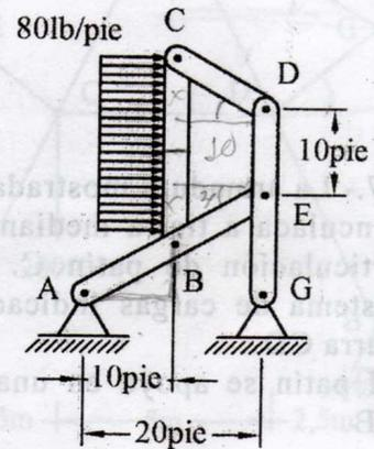
85.- La estructura mostrada formada por diez barras de pesos despreciables, está vinculada a tierra mediante las articulaciones planas A y B. Si la estructura se somete al sistema de cargas indicado; determinar:
