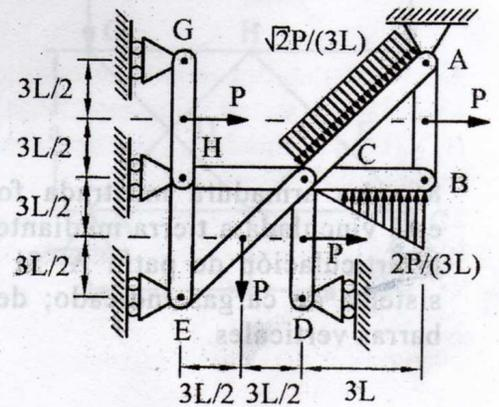
84.- La estructura mostrada formada por cuatro barras de pesos despreciables, está vinculada a tierra mediante las articulaciones planas A y G. Las barras CD y AE forman  $30^\circ$  con la horizontal. Si la estructura se somete al sistema de cargas indicado; determinar:
