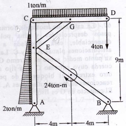
71.- La estructura mostrada formada por dos barras de pesos despreciables y una pieza angular también de peso despreciable, está vinculada a tierra mediante un empotramiento en A y la articulación plana B. Si la estructura se somete al sistema de cargas indicado; determinar las reacciones en el empotramiento.
