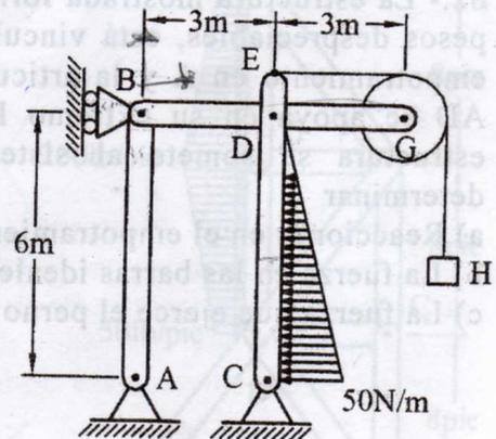
80.- La estructura mostrada formada por cuatro barras de pesos despreciables y una polea de radio 1 m y peso 45 N, está vinculada a tierra mediante las articulaciones planas A y E. La cuerda unida en el punto D de la barra BG sostiene en su otro extremo al bloque H de peso 50 N. Si la estructura se somete al sistema de cargas indicado; determinar:
