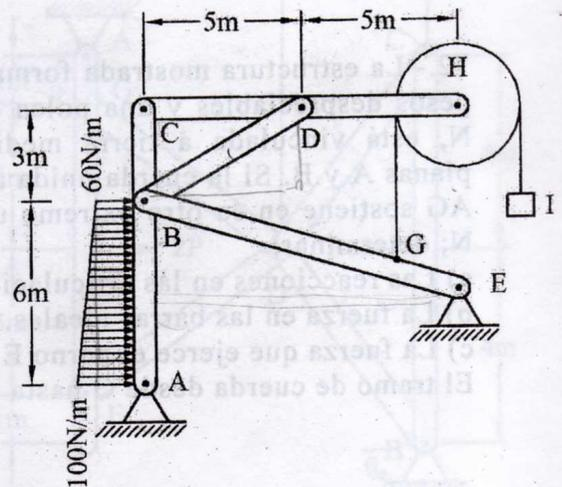
76.- La estructura mostrada formada por tres barras de pesos despreciables y una polea de radio 1 m y peso 30 N, está vinculada a tierra mediante las articulaciones planas A, C y la articulación de rodillo B. La cuerda unida en el punto E de la barra CE sostiene en su otro extremo al bloque H de peso 40 N. Si la estructura se somete al sistema de cargas indicado; determinar:
