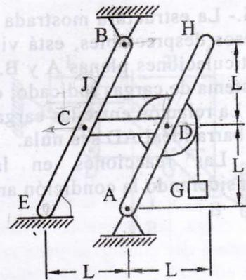
69.- La estructura mostrada formada por seis barras de pesos despreciables, está vinculada a tierra mediante las articulaciones planas A y B. Si la estructura se somete al sistema de cargas indicado; determinar las fuerza en las barras ideales.
