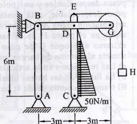
77.- La estructura mostrada formada por cuatro barras de pesos despreciables y una polea de radio 2 m y peso 20 N, está vinculada a tierra mediante las articulaciones planas A y G. La cuerda unida en el punto D de la barra GC sostiene en su otro extremo al bloque I de peso 300 N. Si la estructura se somete al sistema de cargas indicado; determinar:
