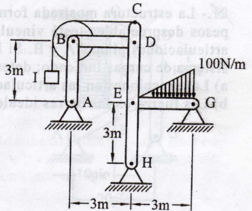
79.- La estructura mostrada formada por tres barras de pesos despreciables y una polea de radio 1 m y peso 30 N, está vinculada a tierra mediante las articulaciones planas A, C y la articulación de rodillo B. La cuerda unida en el punto E de la barra CE sostiene en su otro extremo al bloque H de peso 40 N. Si la estructura se somete al sistema de cargas indicado; determinar:
