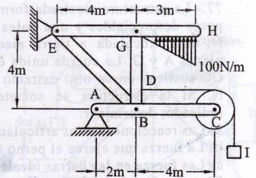
81.- La estructura mostrada formada por cuatro barras de pesos despreciables, está vinculada a tierra mediante las articulaciones planas A y B. Si la estructura se somete al sistema de cargas indicado; determinar:
