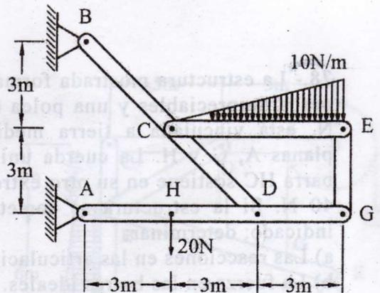
82.- La estructura mostrada formada por cuatro barras de pesos despreciables, está vinculada a tierra mediante un empotramiento en A y la articulación plana B. La barra AD se apoya en su extremo D en la barra BG. Si la estructura se somete al sistema de cargas indicado; determinar
