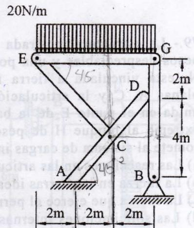
83.- La estructura mostrada formada por ocho barras de pesos despreciables, está vinculada a tierra mediante la articulación plana A y las articulaciones de rodillos D, E, H y G. Si la estructura se somete al sistema de cargas indicado; determinar:
