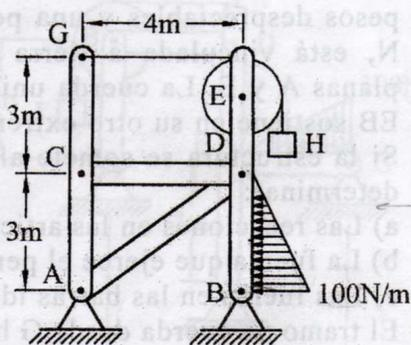
73.- La estructura mostrada formada por tres barras de pesos despreciables y una polea de radio 1 m, también de peso despreciable, está vinculada a tierra mediante la articulación plana A y la cuerda horizontal DE. La cuerda unida en el punto H de la barra AD sostiene en su otro extremo al bloque G de peso 3 Ton. Si la estructura se somete al sistema de cargas indicado; determinar:
