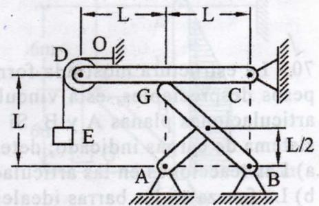
68.- La estructura mostrada formada por tres barras de peso despreciable y una polea también de peso despreciable está vinculada a tierra mediante las articulaciones planas A y B. La barra BE apoya su extremo E en la superficie horizontal lisa fija a tierra. Si la cuerda unida en el punto J de la barra BE sostiene en su otro extremo el bloque G de peso P; determinar:
