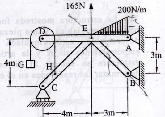
75.- La estructura mostrada formada por cuatro barras de pesos despreciables y una polea de radio 2 m y peso 50 N, está vinculada a tierra mediante las articulaciones planas A y E. La cuerda unida en el punto G de la barra EB sostiene en su otro extremo al bloque I de peso 80 N. Si la estructura se somete al sistema de cargas indicado; determinar:
