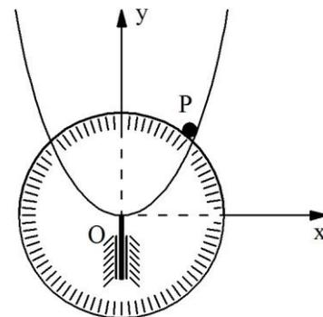
41.- La esfera P de radio despreciable está unida a la cuerda que permanece tensa, y enrollada a la superficie circular de centro O y radio R fija a tierra. Para la configuración mostrada el segmento de cuerda AP es horizontal y su longitud es L. Si La ley de variación del ángulo que forma la cuerda con la horizontal es:
