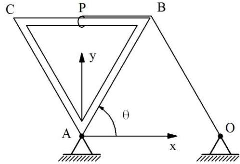
22.- El pasador  $P$  se mueve en la superficie circular de centro  $O$  y radio  $R$  fija a tierra, y simultáneamente en la barra  $AB$  articulada a tierra en  $A$ . La barra gira en sentido horario según la ley de movimiento:
