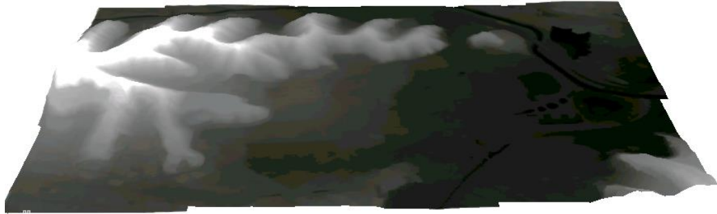
Fig. 51. Modelo Digital de Terreno realizado a partir de data Lidar en ArcGIS Pro. Fuente: Elaboración propia.
