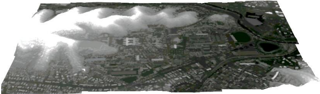
Fig. 53. Modelo Digital de Superficie realizado a partir de data Lidar en ArcGIS Pro. Fuente: Elaboración propia.
