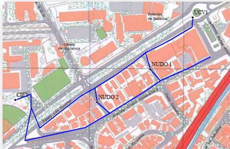
Fig. 43 Densificación de poligonales por bloques a través de nudos poligonales. Elaboración propia
