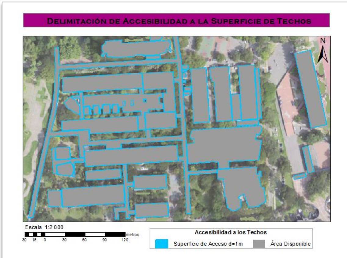
Mapa 10. Delimitación de la accesibilidad en los techos para el mantenimiento de arreglos fotovoltaicos
