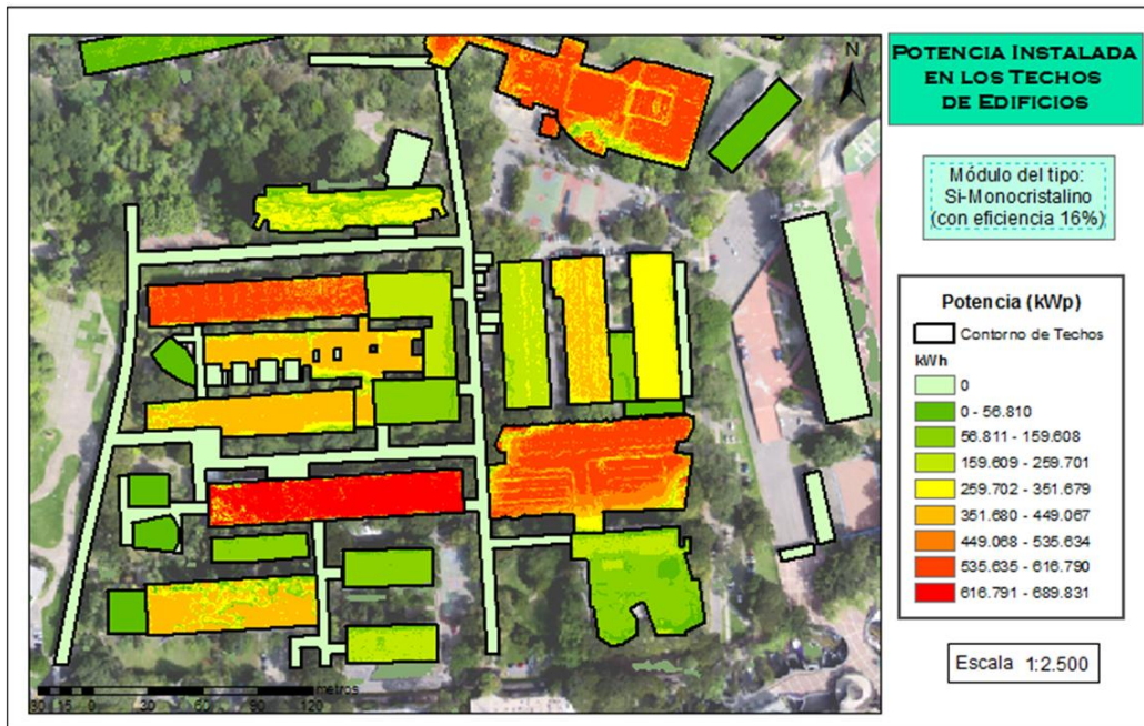
Mapa 22. Energía anual producida por módulos del tipo Si-monocristalino Fuente: Elaboración Propia.
