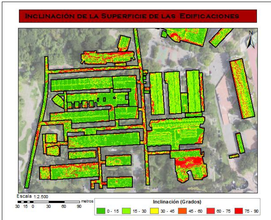
Mapa 3. Inclinación de los techos. Utilizando la herramienta «Slope» de ArcGis 10.1
