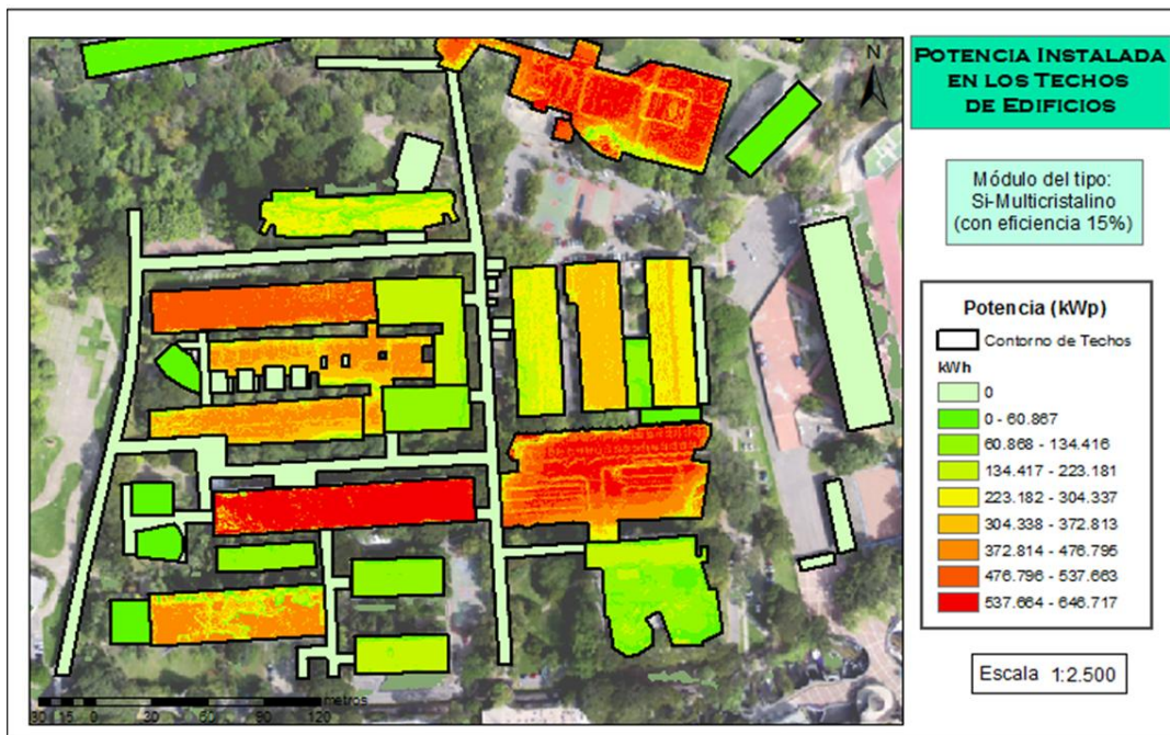
Mapa 23. Energía anual producida por módulos del tipo Si-multicristalino Fuente: Elaboración Propia.
