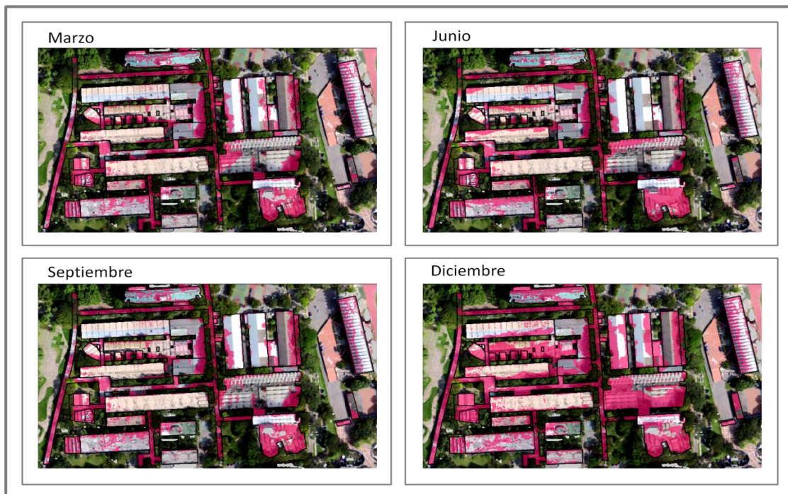
Figura 63. Distribución de las sombras en los techos de los meses correspondientes. Sombras representadas con color magenta
